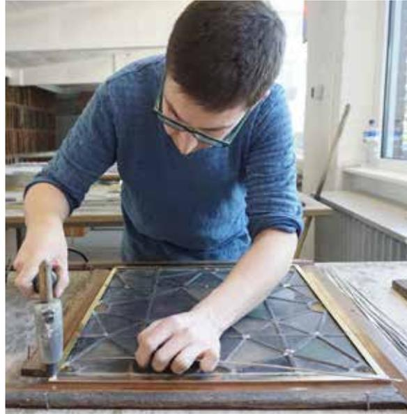
Kontaktpunkte werden zur Stabilisierung mit dem Messingrahmen verlötet
