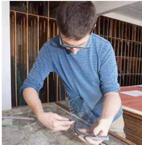
Die Bleiprofile werden um die der Form der Maßwerkfenster folgende Schutzverglasung gebogen
